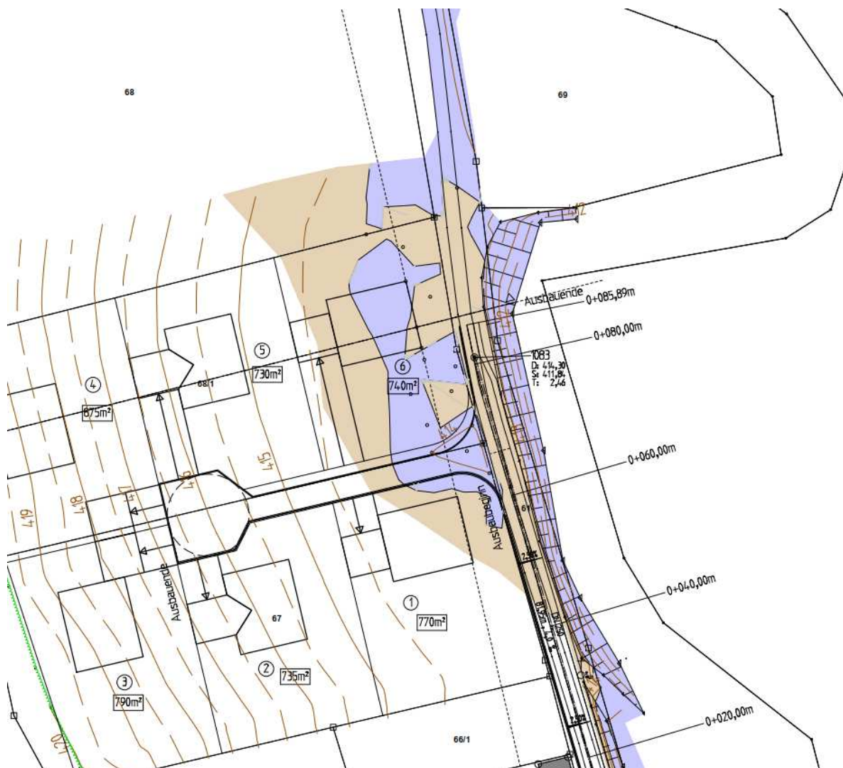
Abbildung 6: Ergebnis der Verschneidung aus den berechneten Wasserspiegellagen HW 100 des LfU mit der durch das Ingenieurbüro Klos vor Ort terrestrisch aufgenommenen Geländehöhe (blau/violett = überflutet, hellbraun/ocker = nicht überflutet)
